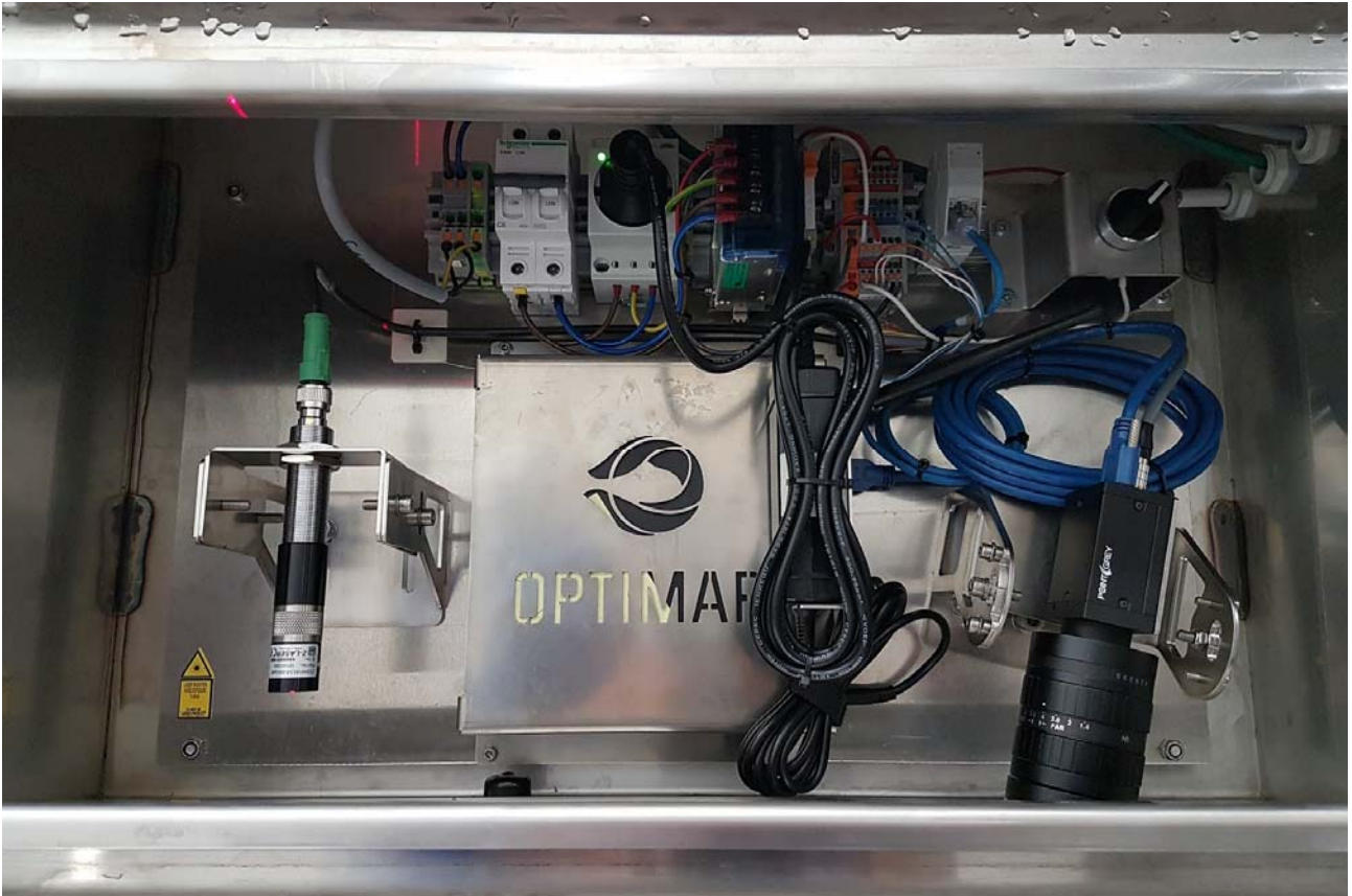
Figur 17: Bilde av kamerahus med Z-laser linjelaser, datamaskin, kamera og elektronikk for å styre laser
